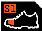
Sicherheitsschuh mit Zehenschutzkappe, die einer Stoßeinwirkung von 200 Joule standhält. Antistatisch, mit Energieaufnahmevermögen im geschlossenen Fersenbereich und kraftstoffbeständig.
