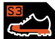
Entspricht S2 und hat zusätzlich eine profilierte Laufsohle sowie eine durchtrittsichere Zwischensohle, um das Eindringen spitzer Gegenstände mit einer Kraft von bis zu 1100 Newton zu verhindern.
