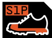
Entspricht S1 und ist zusätzlich verstärkt mit einer durchtrittsicheren Zwischensohle, um das Eindringen spitzer Gegenstände mit einer Kraft von bis zu 1100 Newton zu verhindern.
