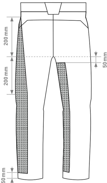
**Rückseite linkes Bein:** Festgelegter Schnittschutzbereich ist ein 50 mm breiter Streifen an der Außenseite des Beines. Dieser erstreckt sich von einer Linie 50 mm oberhalb des unteren Beinabschlusses bis zu einer Höhe von 200 mm unterhalb des Schrittes und läuft in einer Höhe von 200 mm oberhalb des Schrittes aus.
