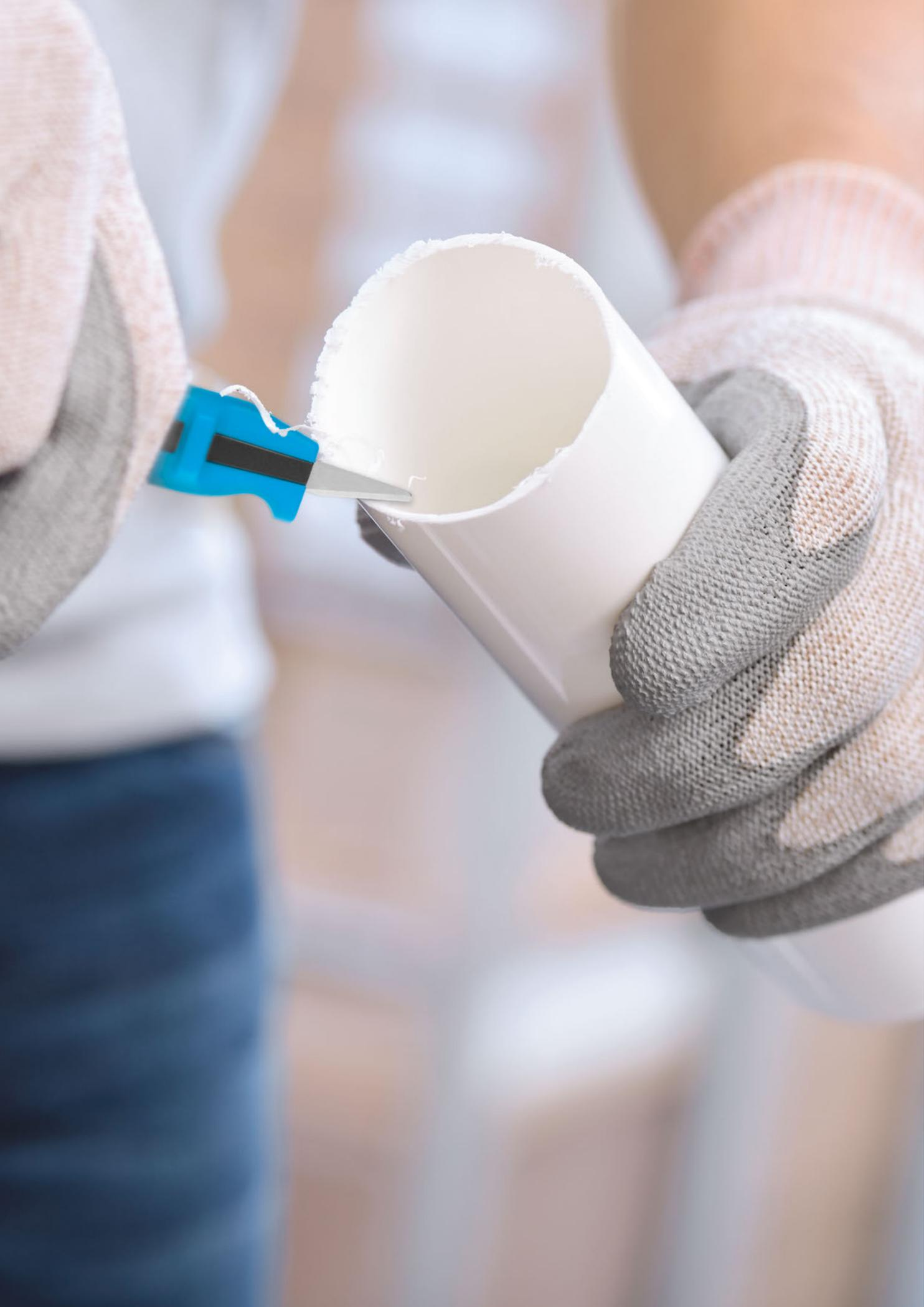
Den letzten Schliff für Ihr Werkstück? Erreichen Sie durch den Einsatz unserer hochwertigen Entgratewerkzeuge. Die TRIMMEX-Familie von MARTOR verwenden Sie zum Entgraten weicher und harter Materialien, auf Innen- und Außenkanten, an runden und geraden Flächen. Unsere Auswahl an passenden Griffen und Klingen ist dabei die Basis für ein sauberes Ergebnis.
